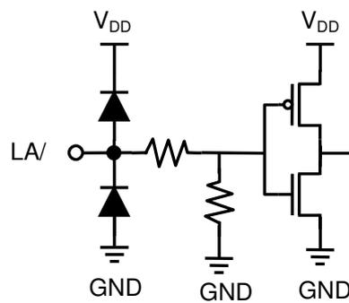
**Equivalent Circuits of Inputs (3)**
